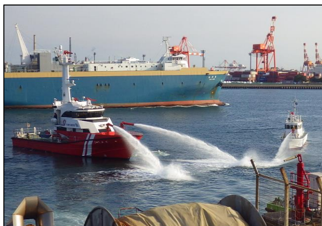
③流出油拡散防止の海面放水状況 (消防艇、警備艇等)
