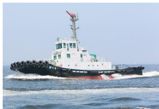
タイヤを防舷材に用いた ダイトーコーポレーション保有船舶 （防災曳船「ほくと」）
