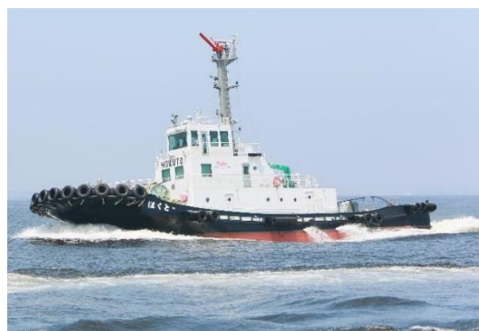
タイヤを防舷材に用いた ダイトーコーポレーション保有船舶 （防災曳船「ほくと」）
